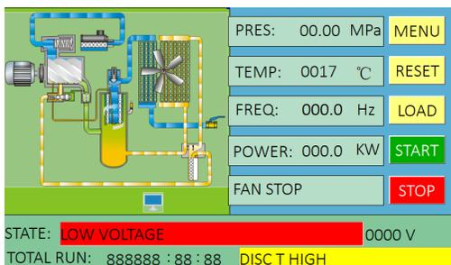
**AVIS :** Le compresseur ne fonctionnera pas si une alerte quelconque apparaît sur l'écran. Appuyez sur le bouton de réinitialisation avant le bouton « START (DÉMARRER) », une fois que l'alerte est corrigée.
