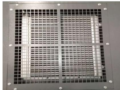
Quand le refroidisseur est recouvert d'un mélange d'huile, de graisse ou d'autres substances lourdes qui pourraient nuire au refroidissement de l'appareil, il est recommandé de nettoyer l'extérieur du cœur du refroidisseur avec soin.
