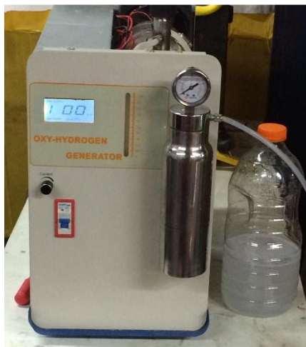
Figuur 9 Opstelling OH generator
